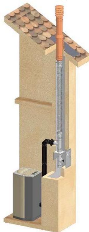
Condotto intubato al servizio di una stufa a pellet
