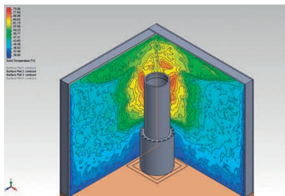
**IT** Simulazione del test di prova per la verifica della temperatura di parete in legno eseguito con software di fluidodinamica ad elementi finiti.
