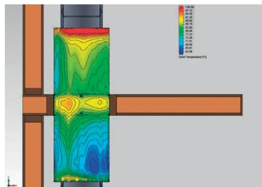
**IT** Simulazione del test di prova per la verifica della temperatura di contatto soletta in legno eseguito con software di fluidodinamica ad elementi finiti.
