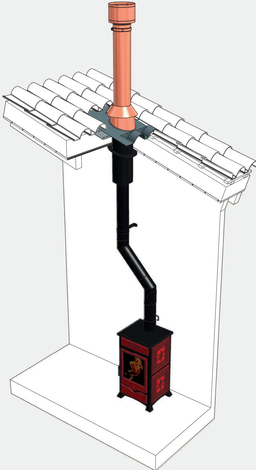
**B****SCARICO IN CONDOTTO INTUBATO****IT****DISCHARGE THROUGH A LINER****ENG****DECHARGEMENT A TRAVERS UN CONDUIT INTUBE****FR**
